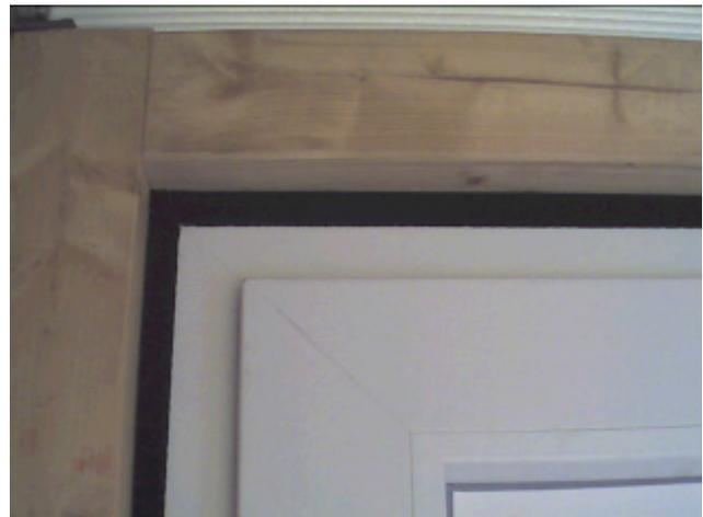
Hinweis: Obige Aufnahmen sind an einer SOFTLINE 82 MD Haustür entstanden. Auf der Außenseite wurde mittels IR-Strahler eine Schwarzkörpertemperatur von 75°C aufgebracht. Die Rauminnenseite wurde auf 23°C temperiert. Wärmebildaufnahmen sind raumseitig aufgenommen. Schloss ist nur in Tagesfalle.
